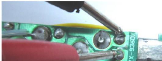
Si el valor de la resistencia no es normal, sustituya el elemento calentador.
