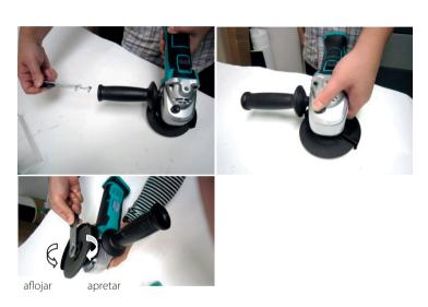
**¡Atención!** Presione el botón de bloqueo del eje solo cuando el eje de la amoladora esté detenido. De lo contrario, puede dañar la herramienta.
