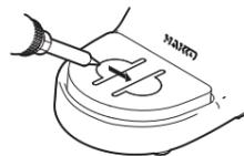
Utilice la esponja de limpieza que acompaña al producto para limpiar la punta. Esta esponja tiene usos muy diversos: desde retirar del exceso de soldadura hasta eliminar por completo los restos generados por la oxidación.
