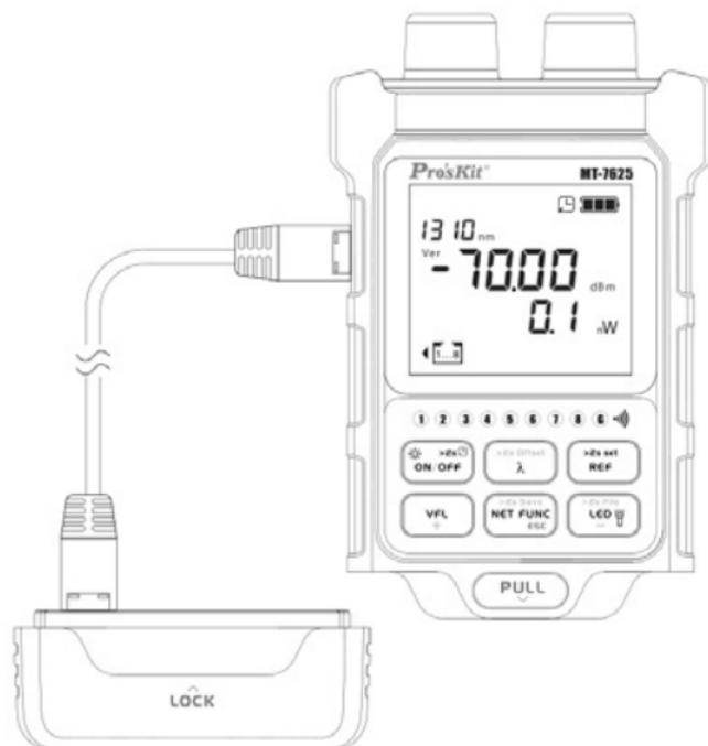
Pulse la tecla "PULL" y extraiga el módulo remoto de prueba del cable de red. Conecte un extremo del cable de red a comprobar a la unidad principal y el otro al módulo remoto.
